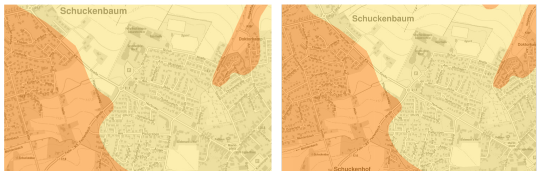
Abbildung 81: Geothermische Potenziale beim Einsatz von Erdwärmesonden in Tiefen von 40 (links oben), 60 (rechts oben) und 80, bzw. 100 m (links unten). [Quelle: Geologischer Dienst NRW, Eigene Darstellung].
