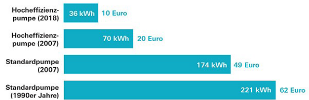
Abbildung 89: Effizienzsteigerung und verbrauchsgebundene Kosten von Heizungs- umwälzpumpen
